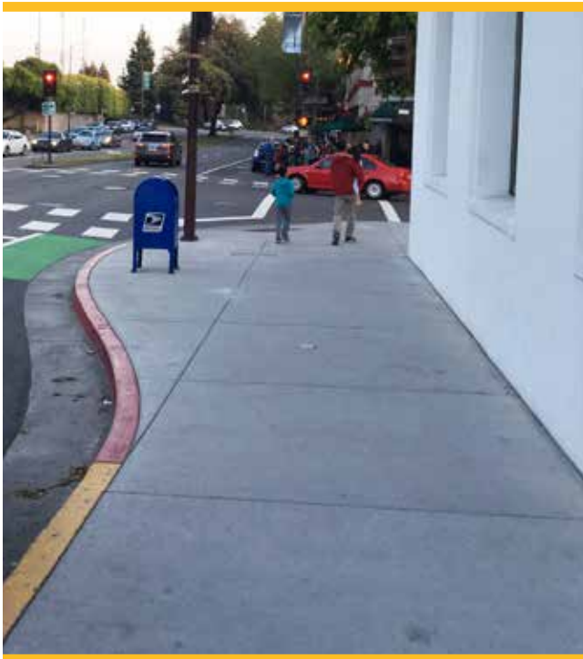
Curb Extension (Bulb-Out)
