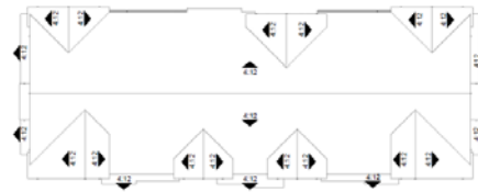
ROOF PLAN 1/8" = 1'-0" SCALE: 1/8" = 1'-0"
